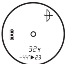
Quando sono visualizzate le distanze della linea di vista da 7 a 199 yarde/metri, l'indicatore della modalità freccia sarà automaticamente visualizzato assieme all'angolo e alla distanza compensata. Se sono visualizzate distanze superiori a 199 yarde/metri, l'indicatore della modalità freccia si spegnerà automaticamente assieme all'angolo e alle distanze compensate.
