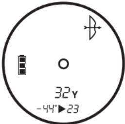
Wenn Visierlinienentfernungen von 7-199 Yards/Metern angezeigt werden, wird die Bogen-Modusanzeige automatisch zusammen mit dem Winkel und einer kompensierten Entfernung angezeigt. Wenn Entfernungen von über 199 Yards/Metern angezeigt werden, schaltet die Bogen-Modusanzeige automatisch zusammen mit dem Winkel und kompensierten Entfernungen aus.
