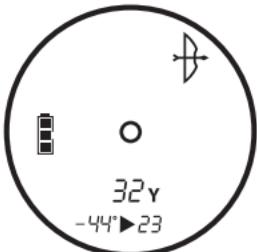
Cuando se muestran distancias de la línea de visión de 7 a 199 yardas/metros, se podrá observar automáticamente el indicador del modo Bow (arco) junto con el ángulo y una distancia compensada. Si se muestran distancias superiores a 199 yardas/metros, el Indicador del modo Bow (arco) se apagará automáticamente, junto con el ángulo y las distancias compensadas.
