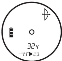
Lorsque les distances de la ligne de mire comprises entre 7 et 199 mètres sont affichées, l'indicateur du mode Tri à l'Arc s'affiche automatiquement aux côtés de l'angle et de la distance compensée. Si des distances supérieures à 199 sont affichées, l'indicateur du mode Tir à l'Arc s'éteint automatiquement, de même que l'angle et les distances compensées.
